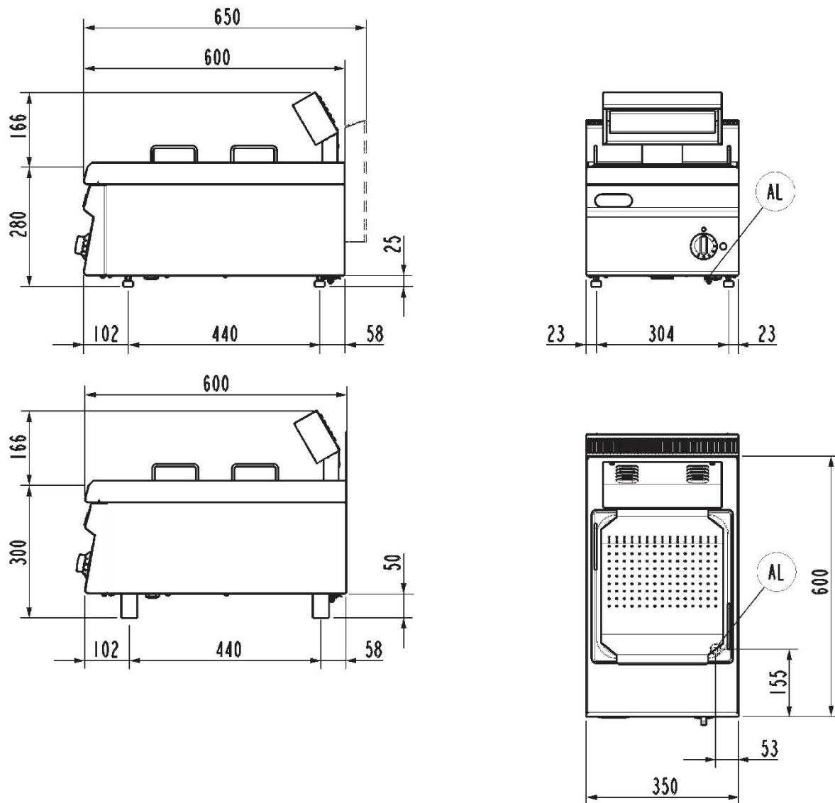
AI = Entrata cavo elettrico | Power supply cable inlet | Netzkabeleingang | Вход электропровода | Entrée câble électrique | Entrada cable eléctrico.
